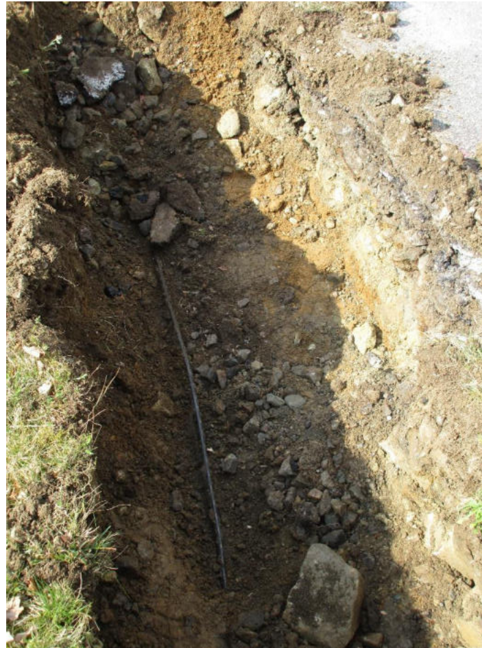
Unter 10 cm mächtiger Asphaltdeckschicht Auffüllungen mit teerhaltigen Asphaltbruchstücken in 40 cm Mächtigkeit
