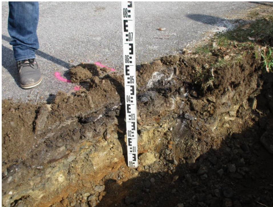
Unter 10 cm mächtiger Asphaltdeckschicht Auffüllungen mit teerhaltigen Asphaltbruchstücken in 40 cm Mächtigkeit
