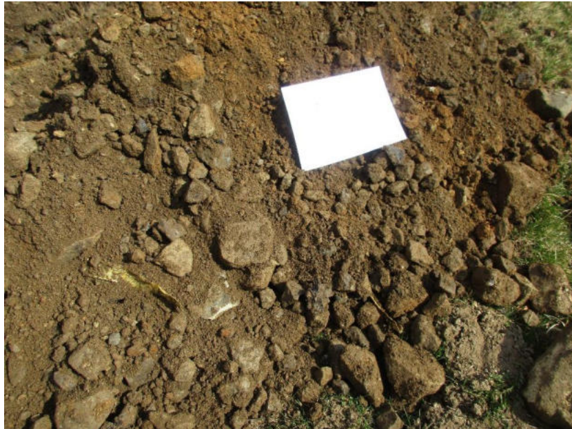
Schürf SCH 5 künstliche Auffüllungen (Abraummaterial) darunter grobsandiger, schluffiger, schwach toniger, mitteldicht gelagerter Zersatzlehm
