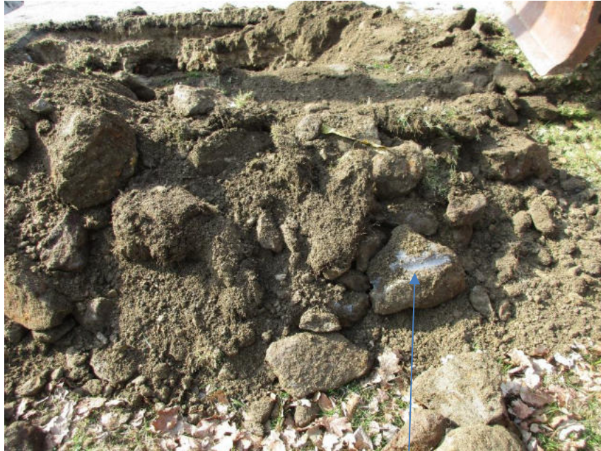
Baggergut aus SCH 01 mit Graphitbruchstücken
