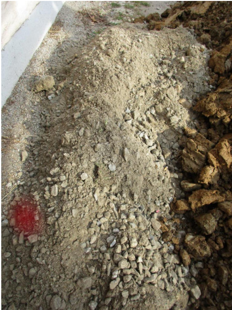
SCH 06 Baggergut (Frostschutz mit steinigem Zersatzlehm)
