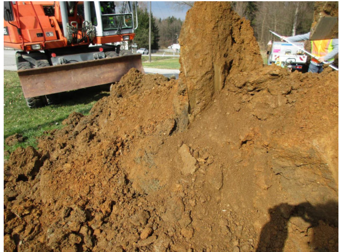
Schürf SCH 5 künstliche Auffüllungen (Abraummaterial) darunter grobsandiger, schluffiger, schwach toniger, mitteldicht gelagerter Zersatzlehm
